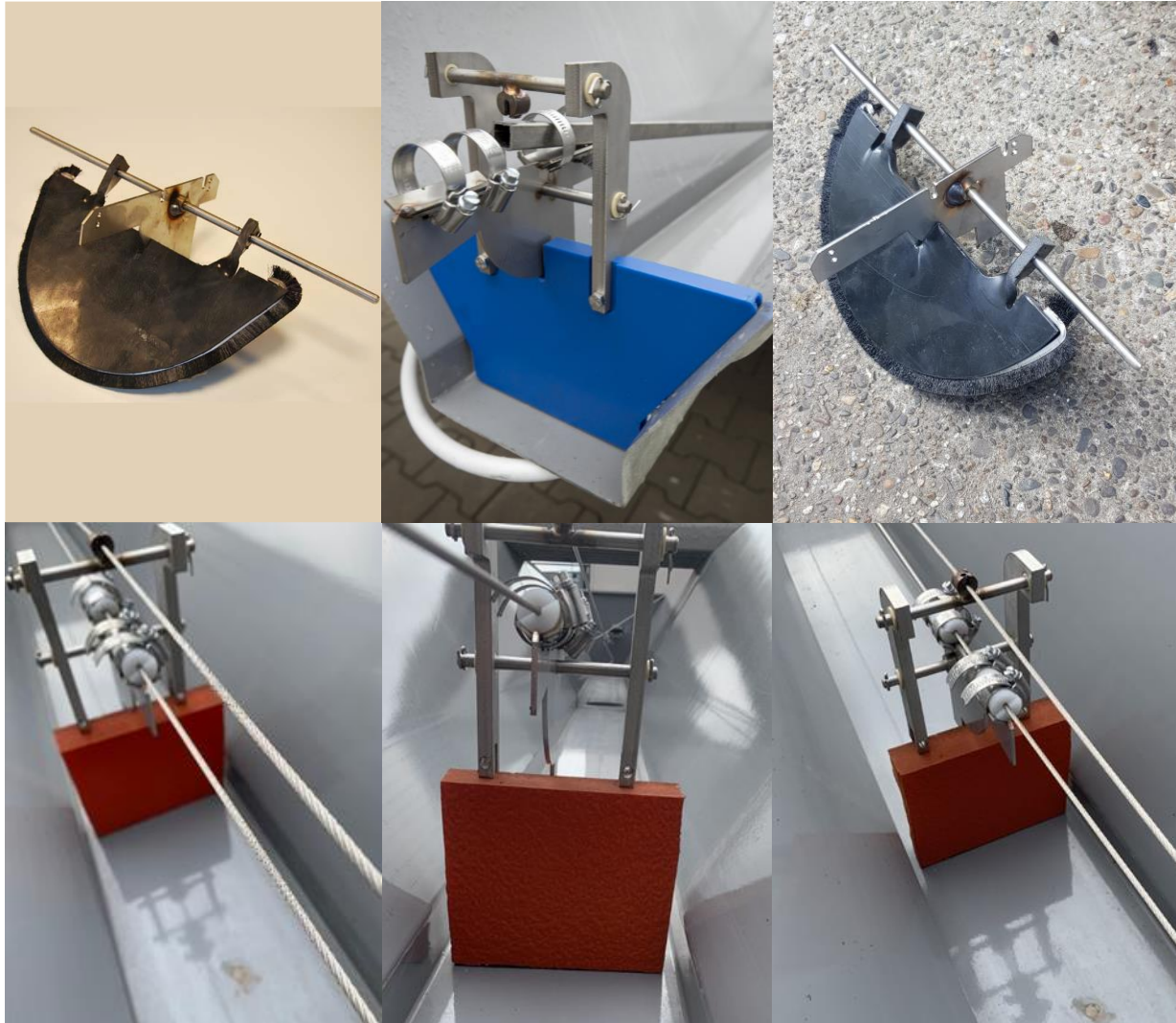
Figuur 2 : Visuele weergave van de klepel in retourstand en in schuifstand
